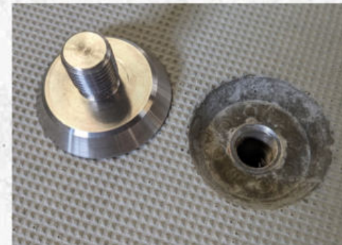
Edelstahl-Verschluss-Deckel für Ankerhülsen - mit Schraubensicherung komplett eindrehen (falls Wasser in der Hülse dies entfernen)
